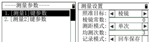
本系列仪器，配备了两个“测量”键，每个测量键可以配置不同的测距参数，在“测量参数”菜单中，选择哪个测量键，就配置哪个键跟随的测量参数。这里以【测量1】键为例。
