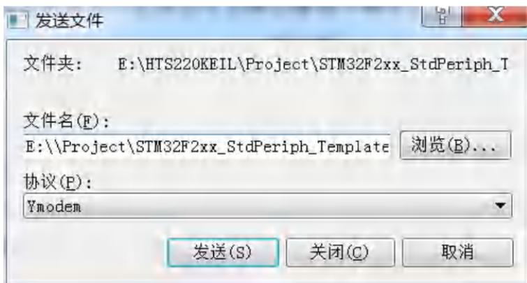
7) 之后显示发送程序的进程，在结束后会再次显示操作项菜单，可以用同样的方法按【5】键更新开机界面和按【6】键更新词条；
